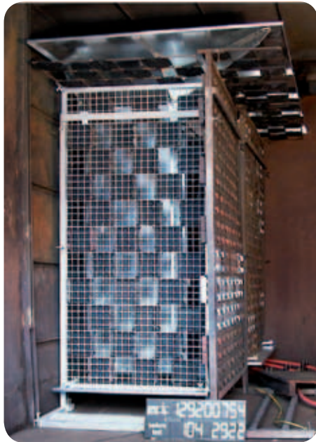
Prüfung des Schaltens induktiver Lasten an einem 800-kV-Leistungsschalter/Inductive load switching test on a 800-kV circuit-breaker
