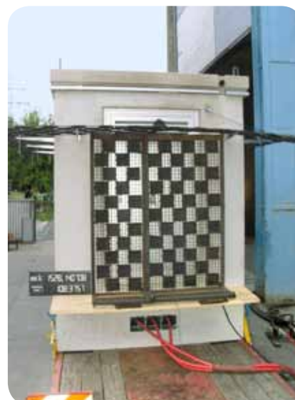
Störlichtbogenprüfung an einer Transformator- Kompaktstation Internal arcing test on a kiosk transformer substation
