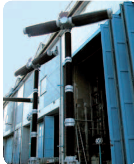
Prüfung des Schaltens induktiver Lasten an einem 800-kV-Leistungsschalter/Inductive load switching test on a 800-kV circuit-breaker
