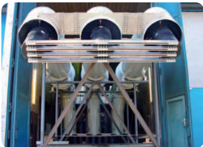
Kurzzeit- und Stoßstromprüfung an einer Generatorausleitung Short-time withstand current and peak withstand current tests on a generator bus duct
