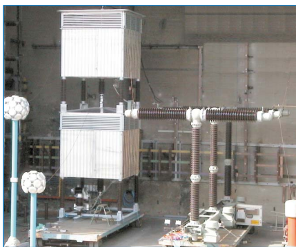
Funkenstrecke vom Typ SIGAP 20 während der Prüfung mit Wiederkehrspannung SIGAP 20 type spark gap during the recovery voltage test
