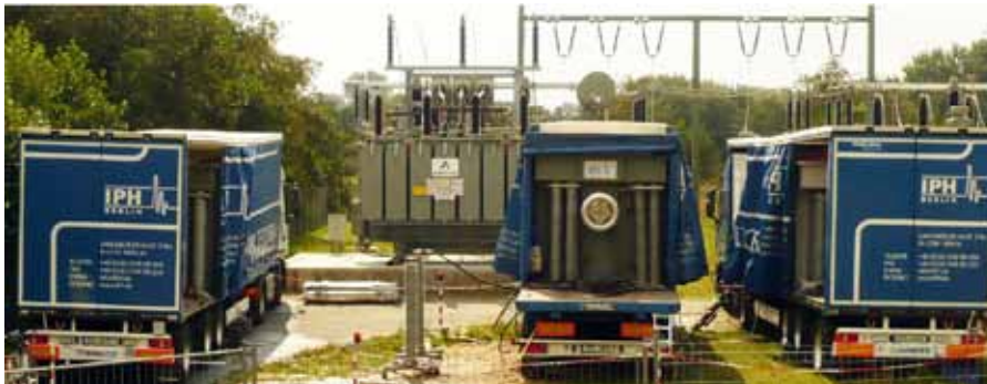
Parallelschaltung dreier Serienresonanzprüfkreise Parallel connection of three series resonant test circuits
