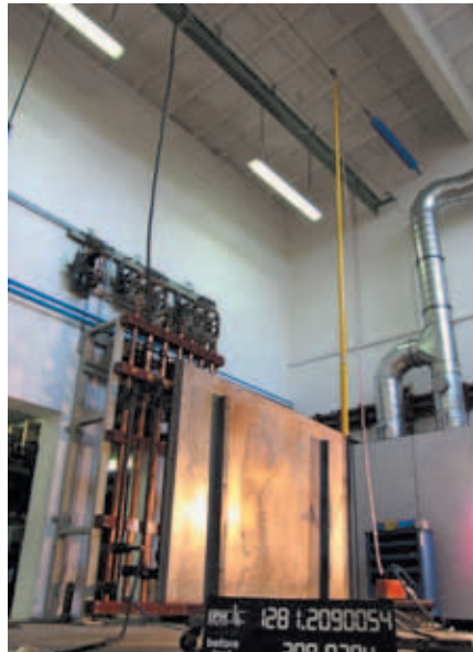
Prüfaufbau der Erdungsvorrichtung mit Erdungsmagnet / Test arrangement of earthing equipment with earthing magnet
