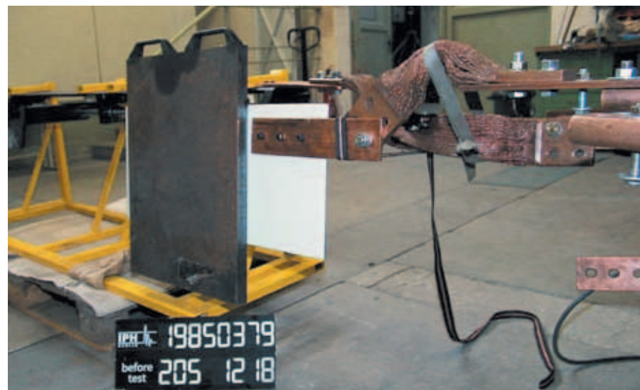
Prüfaufbau mit Türnachbildung / Test arrangement with door mock-up
