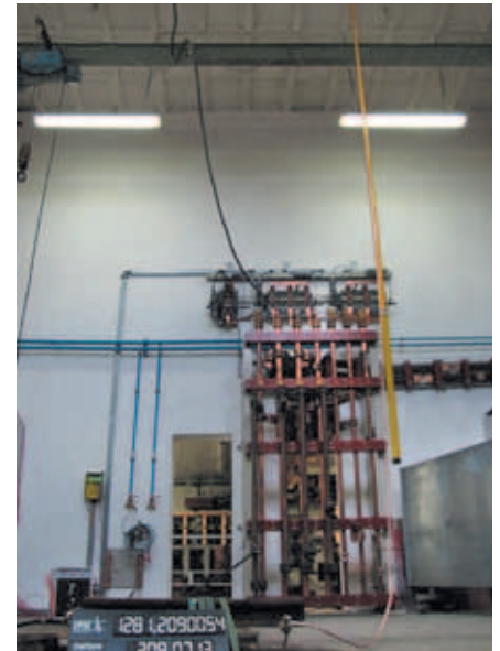
Prüfaufbau der Erdungsvorrichtung mit Erdungsklemme / Test arrangement of earthing equipment with earthing clamp
