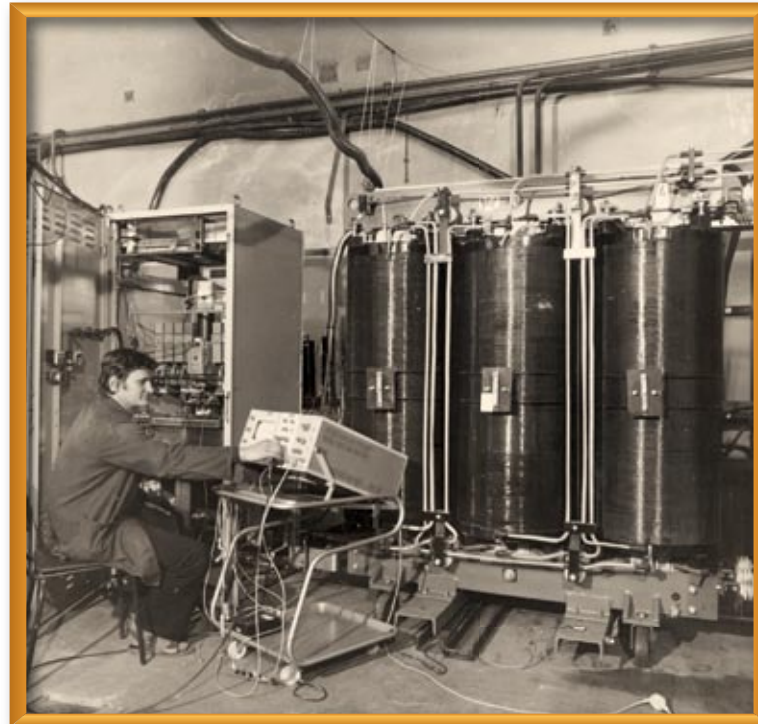
Untersuchungen am Niederspannungs- transformator/Investigations on a LV transformer
