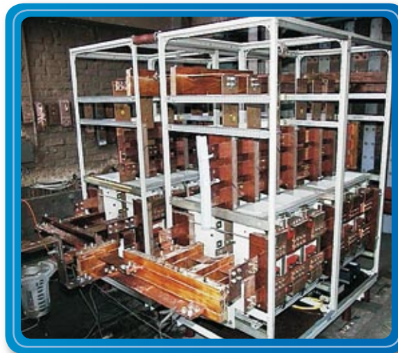
Zwei parallelgeschaltete Gleichrichtermodule/ Two rectifier modules connected in parallel
