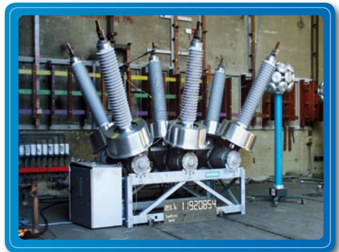
Prüfung an einem 3-poligen Freiluft-HS-Leistungsschalter/ Test on a 3-pole outdoor HV circuit-breaker
